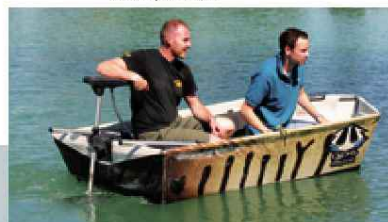
Der leicht schräge Innenboden verstärkt den V-Rumpf und sorgt für Stabilität und eine Wasserlage, die ihresgleichen sucht.
