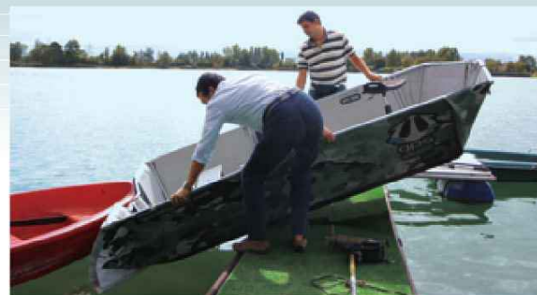
Am Ghost Park setzen Ivan und Massimo das GPS 300 ins Wasser. Gut zu erkennen, die nach außen gezogene Falte der Hülle, die das Boot zum Selbstlenzer macht.
